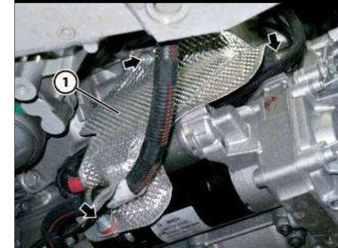
● 拆卸起动机上的隔热罩 (1) (松开指示的三个螺钉并取出相应的衬套)。
