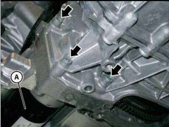
● 松开指示的将起动机 (A) 紧固至变速箱-差速器壳体法兰的三个螺钉。
